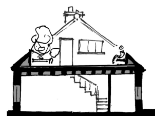
Dépose d'une partie de la toiture et création d'une terrasse
